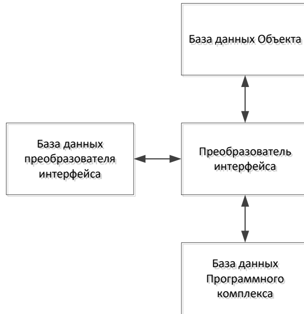
Рисунок 1.2 – Структурная схема преобразователя интерфейса Программного комплекса
